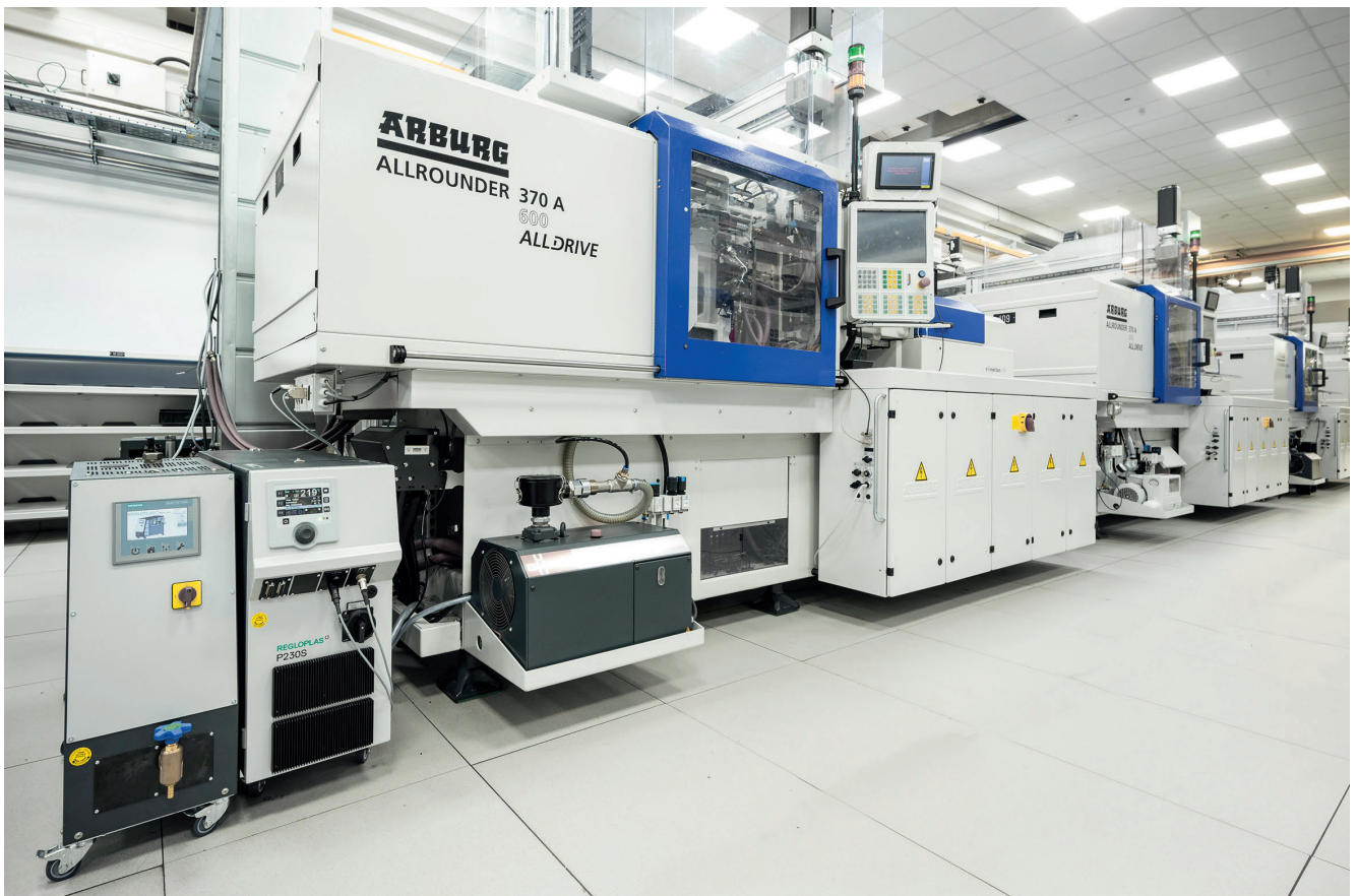
Temperiergerät P230S mit mobiler Wasseraufbereitungsanlage waterCare im Betrieb © Regloplas
